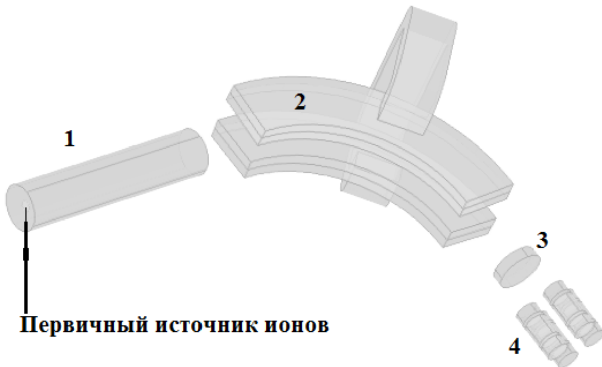
Рисунок 3 - расчётная модель источника. Подписи: система с первичным источником ионов(1), поворотный магнит(2), доускоряющий промежуток(3), электростатическая квадрупольная линза(4).
